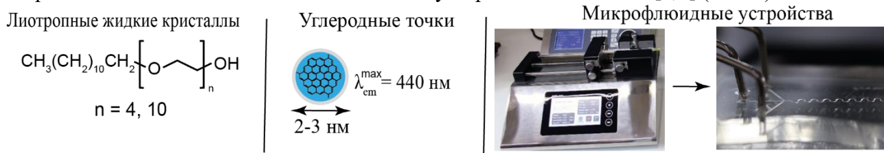
Рисунок 1. Компоненты анизотропных люминесцентных сред на основе лиотропных жидких кристаллов и углеродных наноточек и микрофлюидные устройства.
