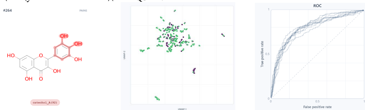
Рисунок 1. Элементы интерфейса SarMath для анализа вклада фрагментов (слева), отображения химического пространства (в центре) и оценки точности модели QSAR (справа).
