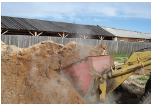
Рис. 2. Перемешивание компостной массы через 1 месяц после начала переработки
